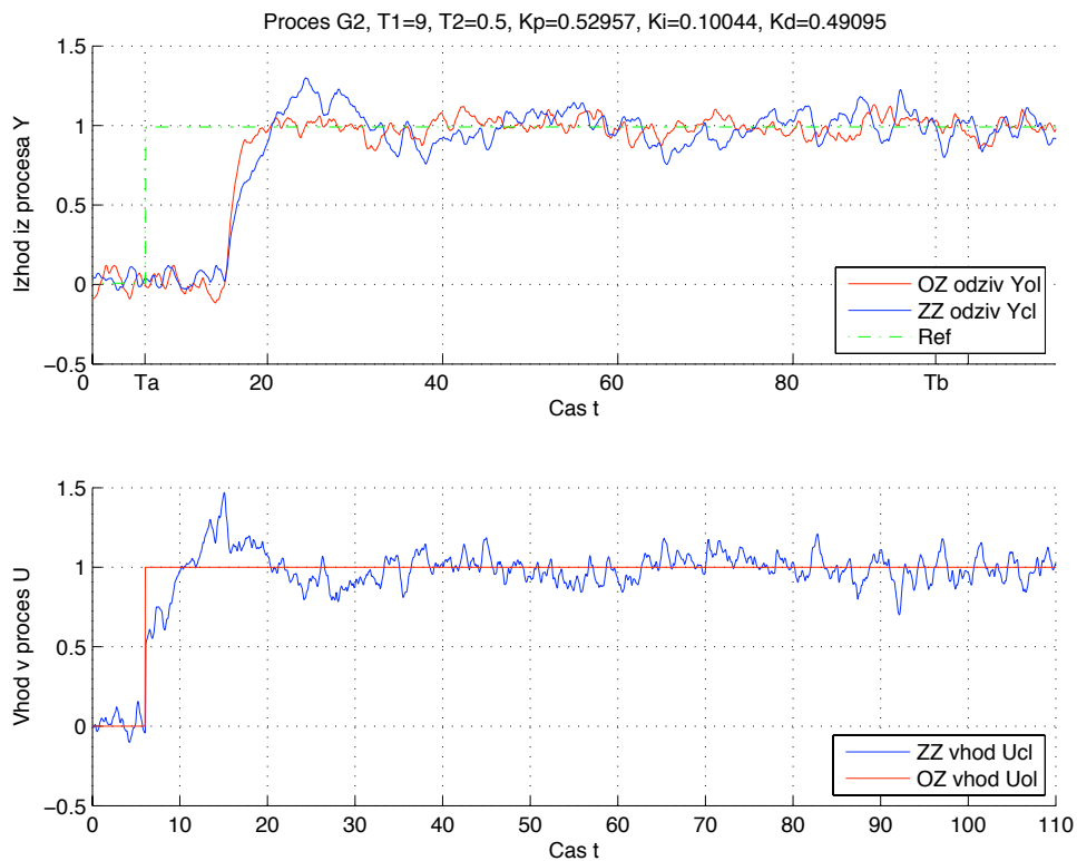
Slika 202: Odprtozančni in zaprtozančni odziv y_{OL}(t) in y_{CL}(t) ter referenčni signal r(t) uporabljen pri simulaciji zaprte zanke modela procesa G_{P2}(s) (zgoraj). Odprtozančno vzbujanje u_{OL}(t) ter vhod v proces v zaprti zanki u_{CL}(t) (spodaj).
