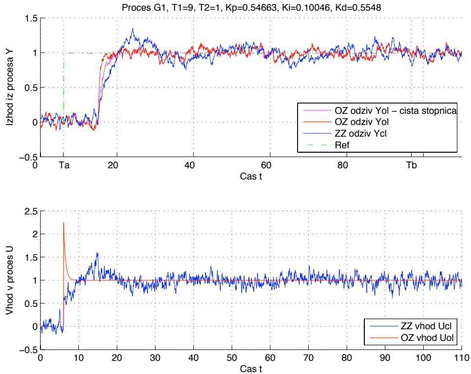
Slika 253: Odprtozančni in zaprtozančni odziv y_{OL}(t) in y_{CL}(t) ter referenčni signal r(t) uporabljen pri simulaciji zaprte zanke modela procesa G_{P1}(s) (zgoraj). Odprtozančno vzbujanje u_{OL}(t) ter vhod v proces v zaprti zanki u_{CL}(t) (spodaj).
