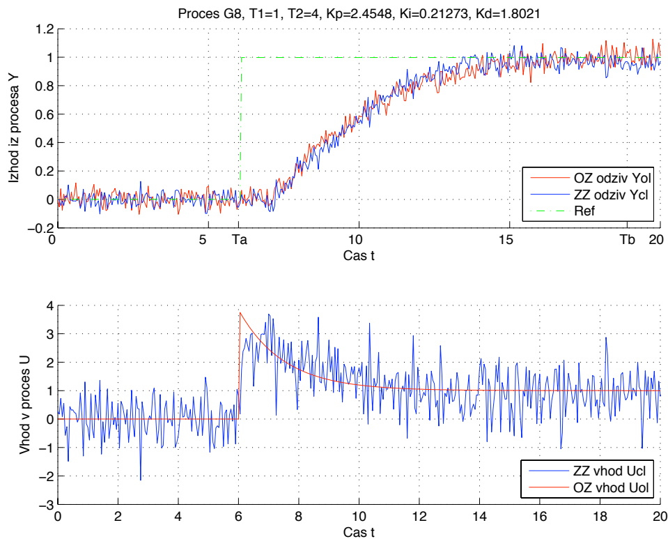
Slika 164: Odprtozančni in zaprtozančni odziv y_{OL}(t) in y_{CL}(t) ter referenčni signal r(t) uporabljen pri simulaciji zaprte zanke modela procesa G_{P8}(s) (zgoraj). Odprtozančno vzbujanje u_{OL}(t) ter vhod v proces v zaprti zanki u_{CL}(t) (spodaj).
