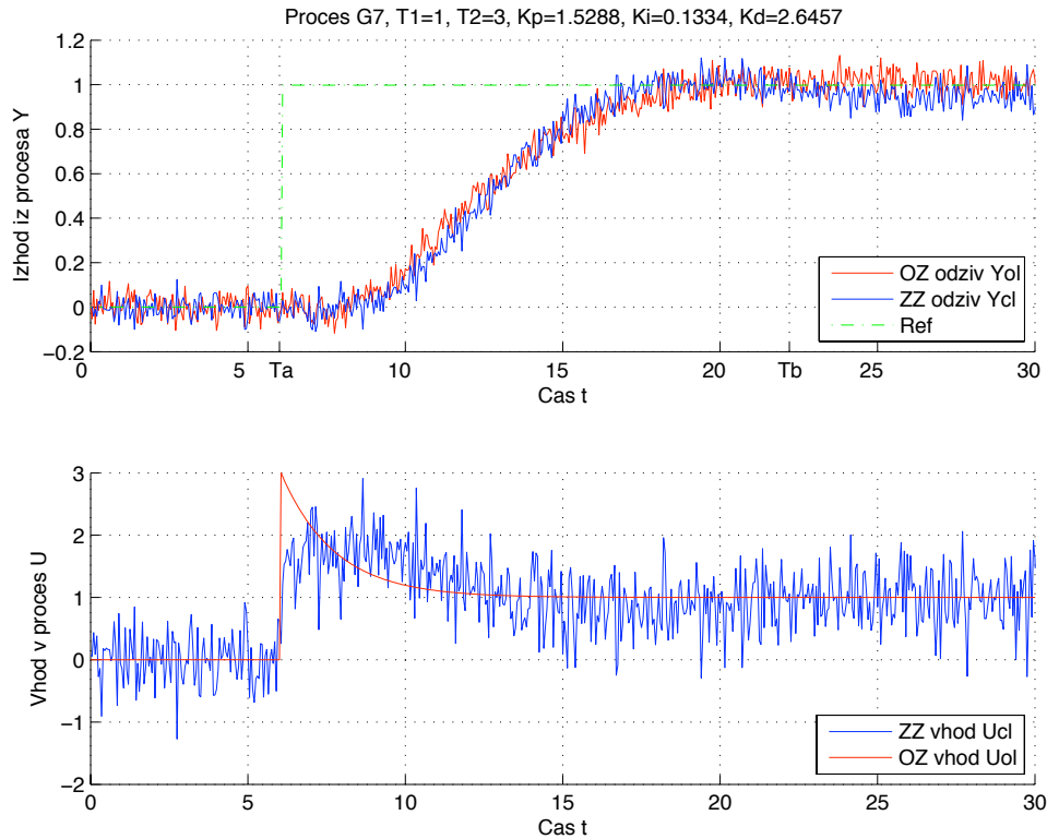
Slika 161: Odprtozančni in zaprtozančni odziv y_{OL}(t) in y_{CL}(t) ter referenčni signal r(t) uporabljen pri simulaciji zaprte zanke modela procesa G_{P7}(s) (zgoraj). Odprtozančno vzbujanje u_{OL}(t) ter vhod v proces v zaprti zanki u_{CL}(t) (spodaj).
