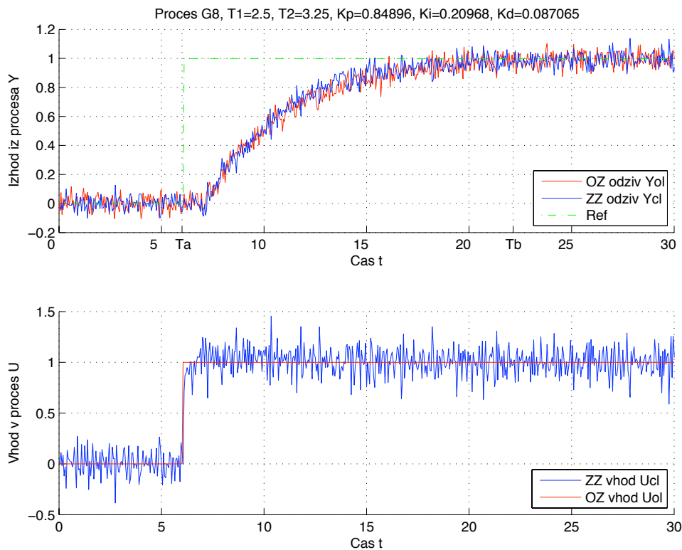
Slika 139: Odprtozančni in zaprtozančni odziv y_{OL}(t) in y_{CL}(t) ter referenčni signal r(t) uporabljen pri simulaciji zaprte zanke modela procesa G_{P8}(s) (zgoraj). Odprtozančno vzbujanje u_{OL}(t) ter vhod v proces v zaprti zanki u_{CL}(t) (spodaj).
