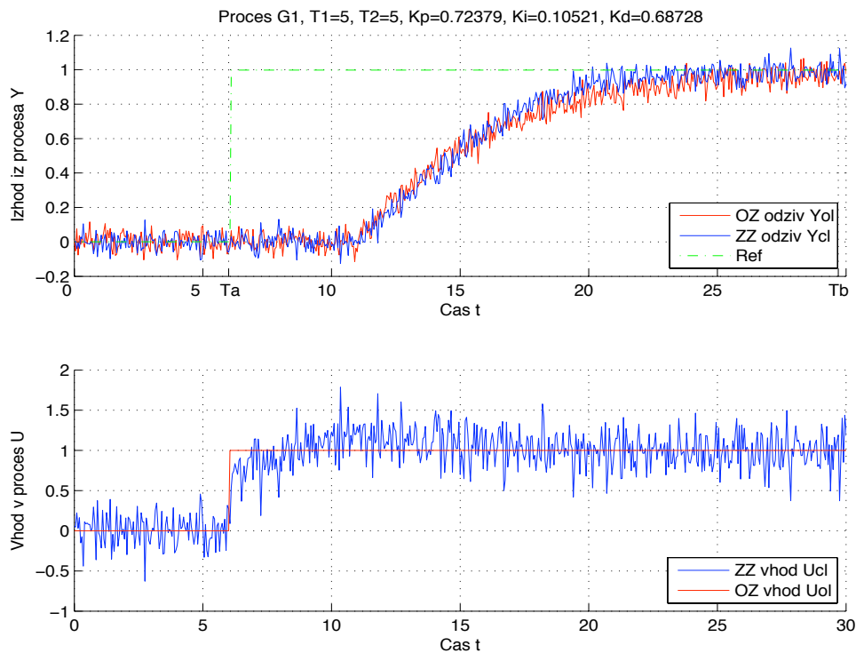
Slika 117: Odprtozančni in zaprtozančni odziv y_{OL}(t) in y_{CL}(t) ter referenčni signal r(t) uporabljen pri simulaciji zaprte zanke modela procesa G_{P1}(s) (zgoraj). Odprtozančno vzbujanje u_{OL}(t) ter vhod v proces v zaprti zanki u_{CL}(t) (spodaj).
