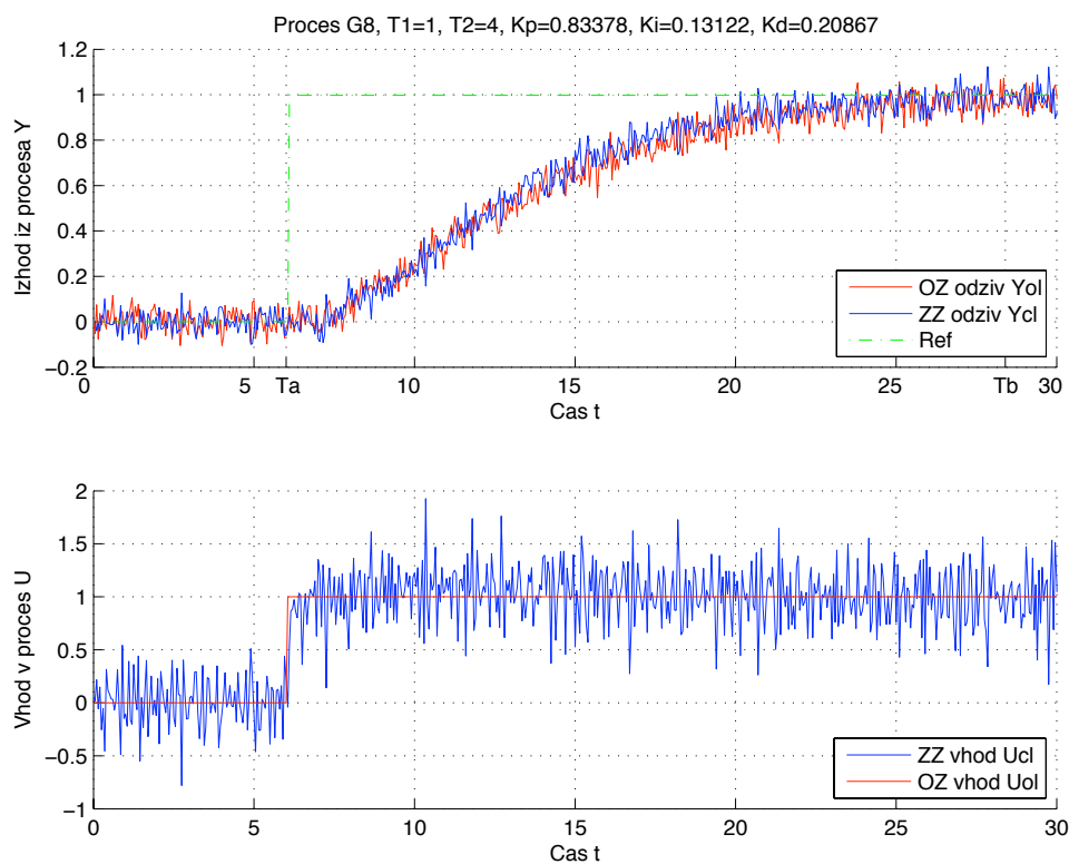
Slika 137: Odprtozančni in zaprtozančni odziv y_{OL}(t) in y_{CL}(t) ter referenčni signal r(t) uporabljen pri simulaciji zaprte zanke modela procesa G_{P8}(s) (zgoraj). Odprtozančno vzbujanje u_{OL}(t) ter vhod v proces v zaprti zanki u_{CL}(t) (spodaj).
