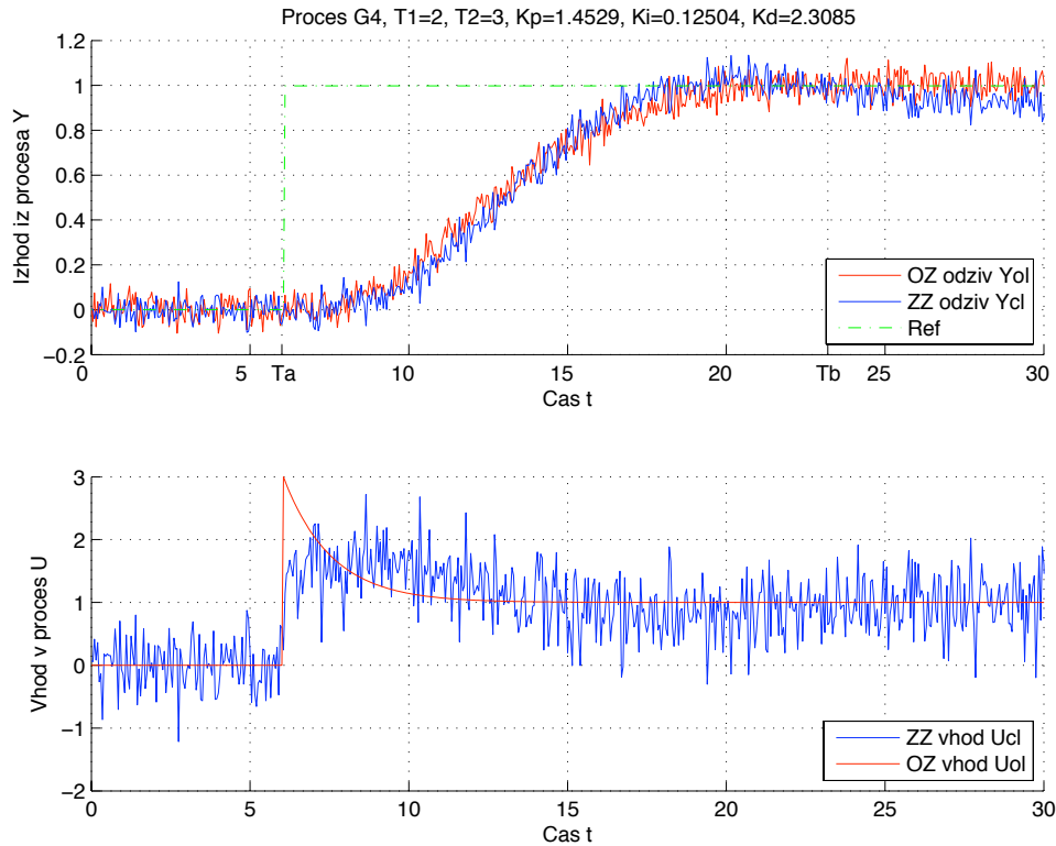
Slika 153: Odprtozančni in zaprtozančni odziv y_{OL}(t) in y_{CL}(t) ter referenčni signal r(t) uporabljen pri simulaciji zaprte zanke modela procesa G_{P4}(s) (zgoraj). Odprtozančno vzbujanje u_{OL}(t) ter vhod v proces v zaprti zanki u_{CL}(t) (spodaj).
