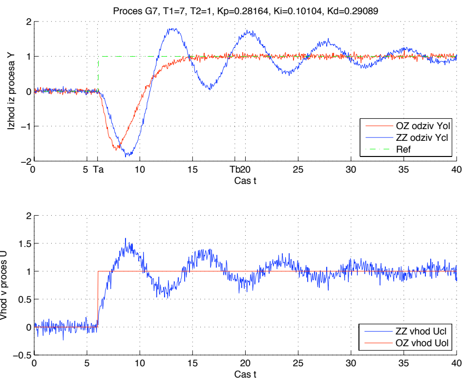
Slika 136: Odprtozančni in zaprtozančni odziv y_{OL}(t) in y_{CL}(t) ter referenčni signal r(t) uporabljen pri simulaciji zaprte zanke modela procesa G_{P7}(s) (zgoraj). Odprtozančno vzbujanje u_{OL}(t) ter vhod v proces v zaprti zanki u_{CL}(t) (spodaj).
