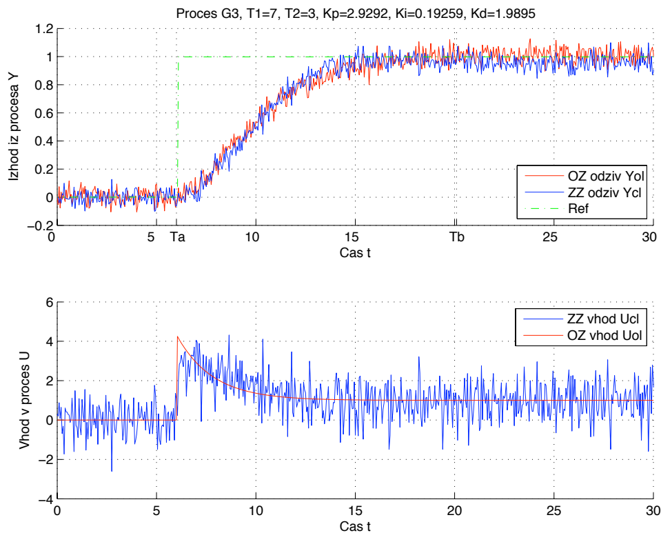
Slika 150: Odprtozančni in zaprtozančni odziv y_{OL}(t) in y_{CL}(t) ter referenčni signal r(t) uporabljen pri simulaciji zaprte zanke modela procesa G_{P3}(s) (zgoraj). Odprtozančno vzbujanje u_{OL}(t) ter vhod v proces v zaprti zanki u_{CL}(t) (spodaj).
