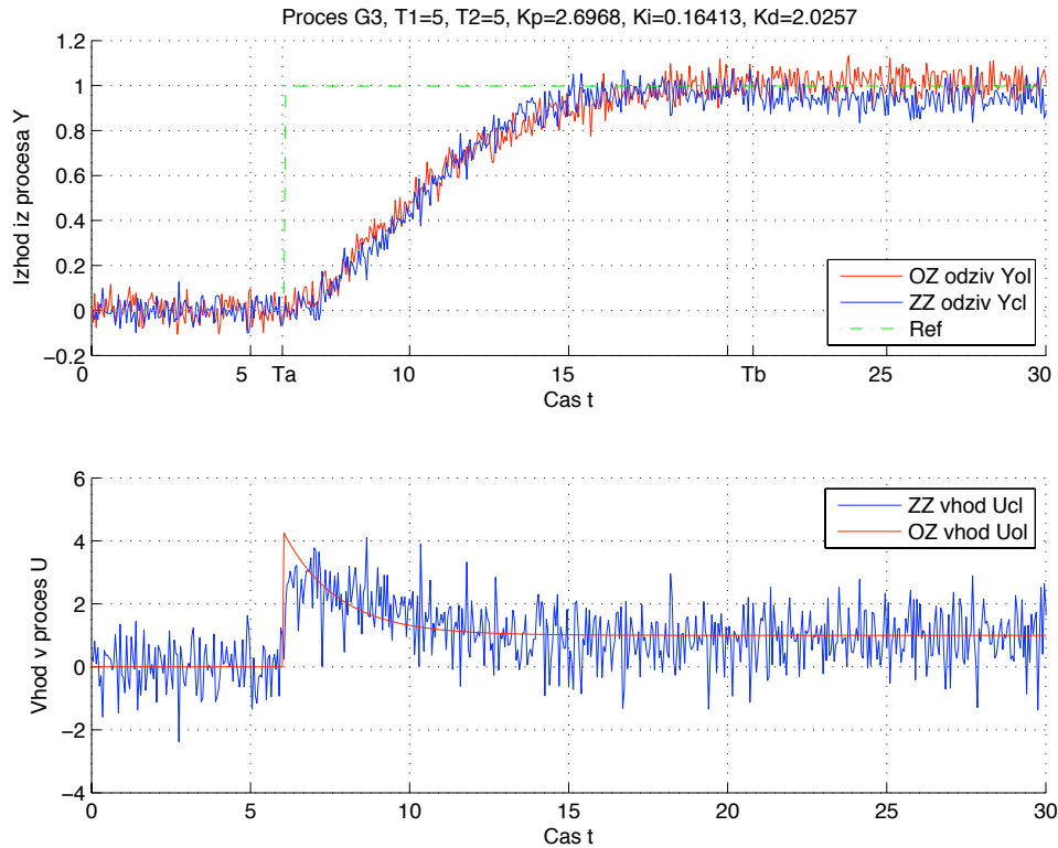
Slika 151: Odprtozančni in zaprtozančni odziv y_{OL}(t) in y_{CL}(t) ter referenčni signal r(t) uporabljen pri simulaciji zaprte zanke modela procesa G_{P3}(s) (zgoraj). Odprtozančno vzbujanje u_{OL}(t) ter vhod v proces v zaprti zanki u_{CL}(t) (spodaj).
