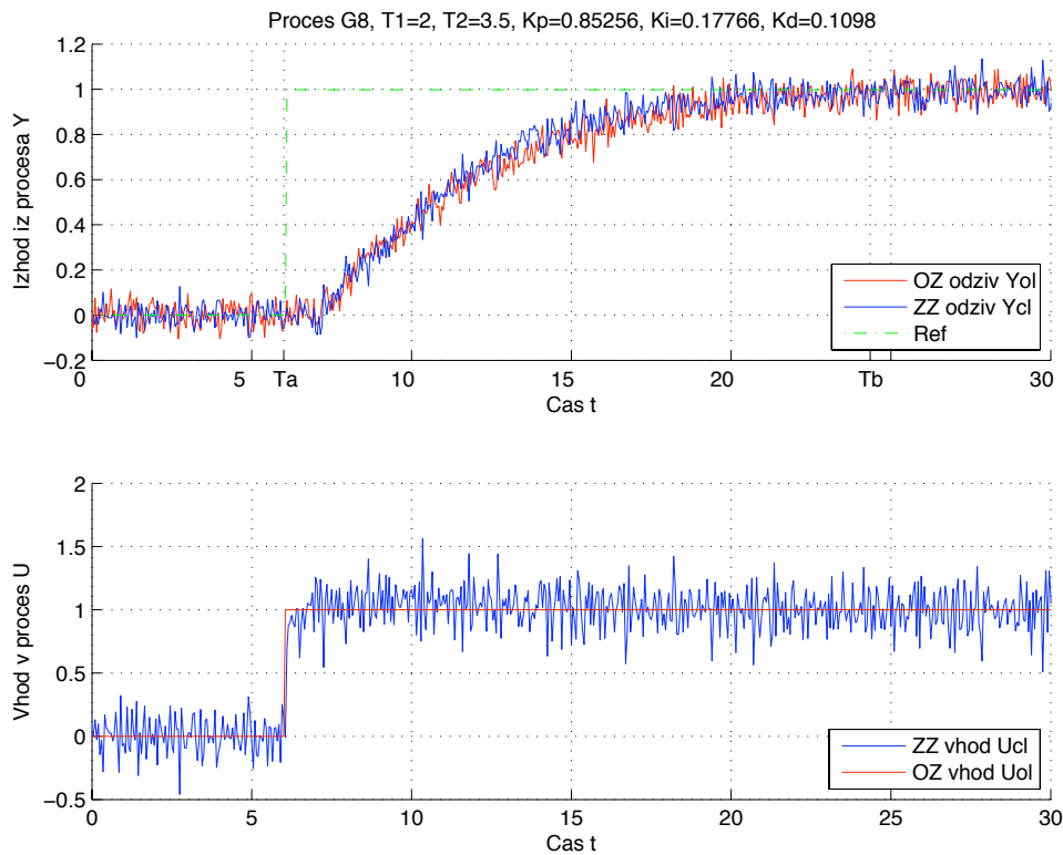
Slika 165: Odprtozančni in zaprtozančni odziv y_{OL}(t) in y_{CL}(t) ter referenčni signal r(t) uporabljen pri simulaciji zaprte zanke modela procesa G_{P8}(s) (zgoraj). Odprtozančno vzbujanje u_{OL}(t) ter vhod v proces v zaprti zanki u_{CL}(t) (spodaj).
