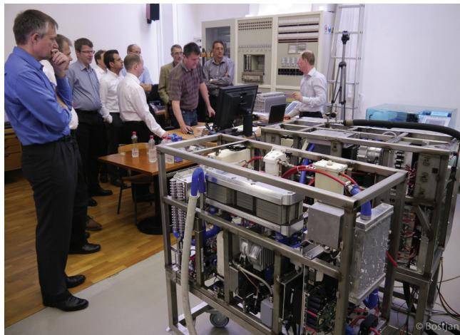
Slika 2: Pričak delovanja agregata z gorivnimi celicami in dizelskim reformerjem med sklepnim sestankom projekta FCGEN
