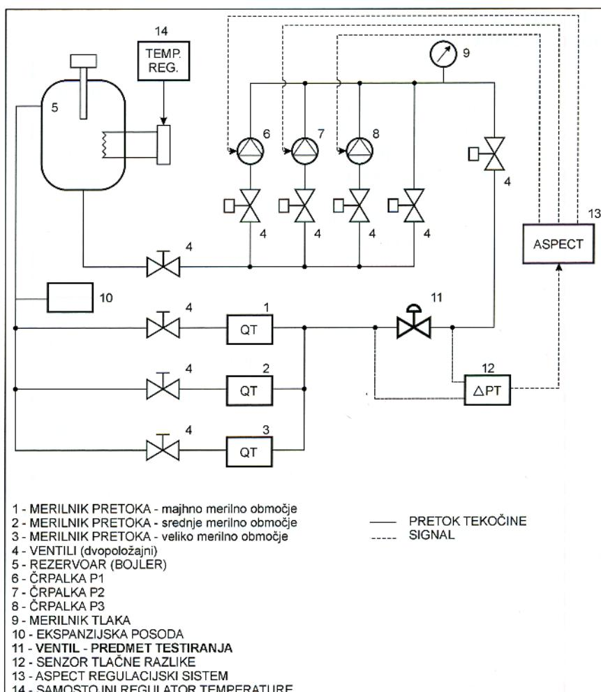
Slika 4. Tehnološka shema testne linije
