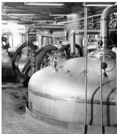
Sl. 3.15. Gornji del šaržnega fermentorja za pridobivanje antibiotika
