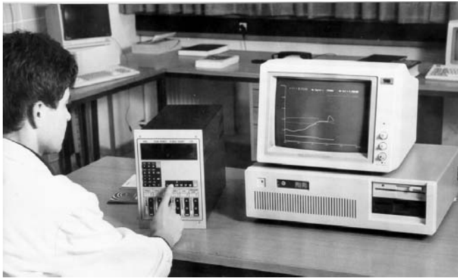
Sl. 5.9. Testiranje algoritmov vodenja v realnem času z uporabo simulatorja procesa
